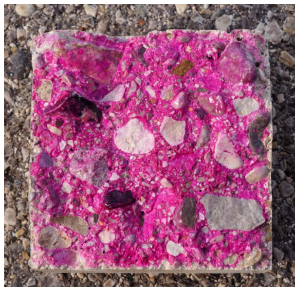
Carbonatisierungs-Prüfung zum Nachweis der Dauerhaftigkeit
